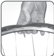
Ilustración 2. Apriete la cubierta para que sobresalga la válvula
