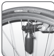
Ilustración 7. Inflado de la cubierta con el cartucho en posición vertical
