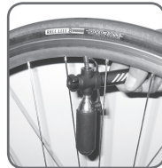
Abbildung 7: Beim Aufpumpen Kartusche in aufrechter Position
