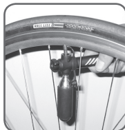
Figure 7. Gonflage du pneu avec la cartouche en position verticale
