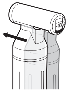
Figure 7. Le cylindre glisse vers la valve pour gonfler
